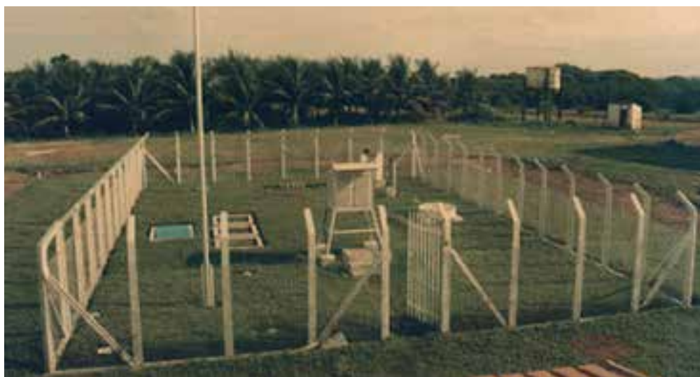
Figura 03 – Estação Meteorológica Convencional
