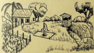
Fig. 1 — Poço a pequena distância de curso d'água confinado.
