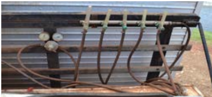
FIGURA 3.10 - Fluxômetro / Manômetro de oxigênio FONTE: Unioeste GEMAg.
