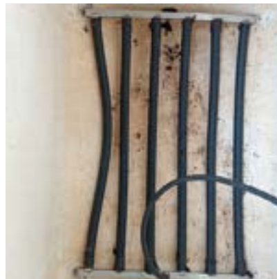
FIGURA 3.11 - Difusores de ar utilizados nos tanques de transporte FONTE: Unioeste GEMAg.
