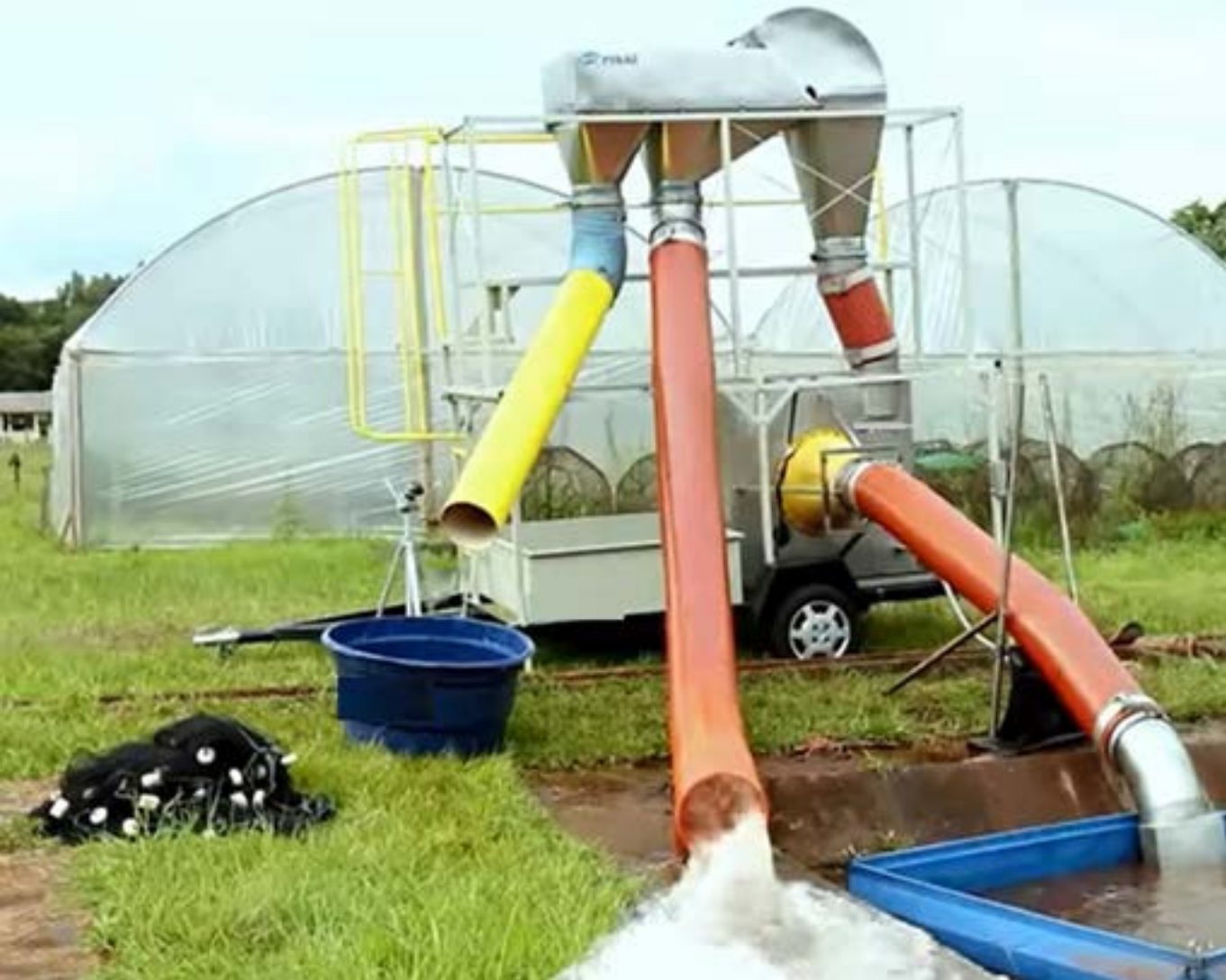
FIGURA 2.12 - Bomba de despesca
