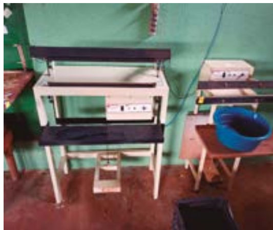
FIGURA 3.25 - Mesa seladora térmica de fechamento das embalagens plásticas, para o transporte de alevinos de peixes
